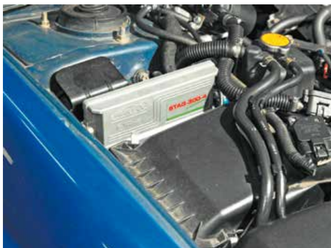
Рис.6 Рекомендуемая позиция монтажа командоконтроллера газа
