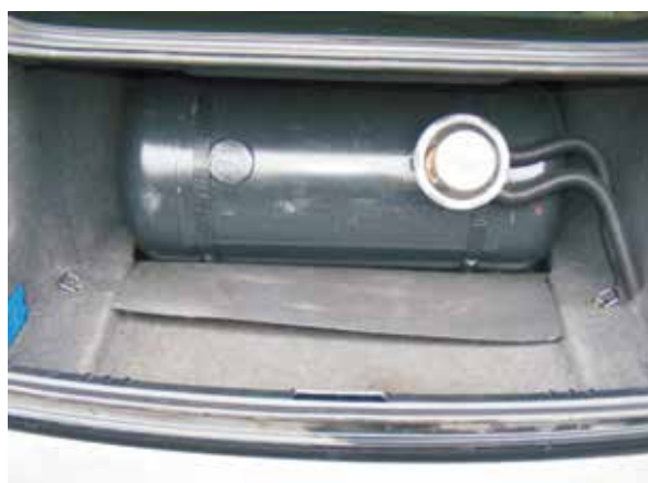
Рис.10 Цилиндрический резервуар за задним сидением
