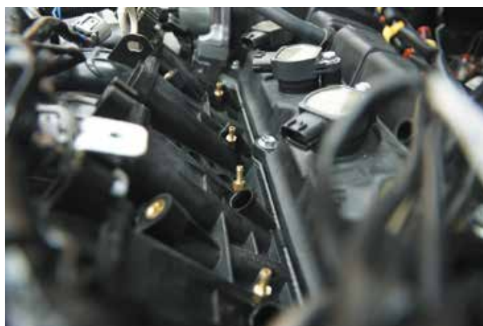
Рис.5 Правильно ввинченные сопла в коллектор всасывания
