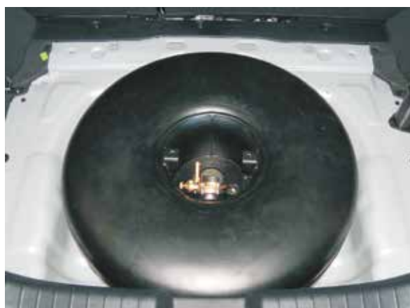
Рис.9 Тороидальный резервуар на месте запасного колеса
